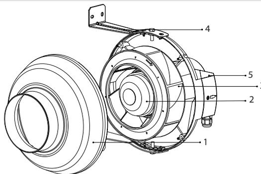
Вентилятор оборудован однофазным двигателем с внешним ротором, оснащенный центробежным рабочим колесом; модель серии "Дуо" — двухскоростным асинхронным двигателем. Вентилятор рассчитан на продолжительную работу без отключения от сети.
