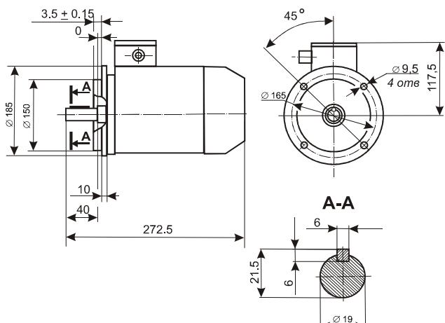
Двигатели изготавливаются по ТУ РБ 05755950-420-93. Двигатели АИР71Ш предназначены для привода промышленных швейных машин при работе от сети частоты 50 Гц.
