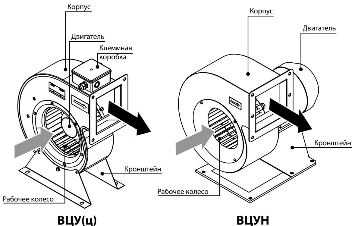
Вентилятор серии **ВЦУН** состоит из металлического корпуса, к которому через фланец прикреплен электродвигатель и впускное кольцо. На приводном валу закреплено рабочее колесо. Снизу к электромотору прикреплен кронштейн для монтажа вентилятора. Вентиляторы ВЦУН изготавливаются в правосторонней и левосторонней модификации. В первом случае рабочее колесо вращается по часовой стрелке, а во втором – против часовой стрелки, вид со стороны притока воздуха.
