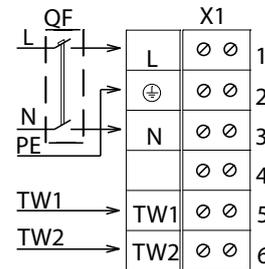
**3. ВЦУ(ц) с магнитным пускателем и термоконтактом**
