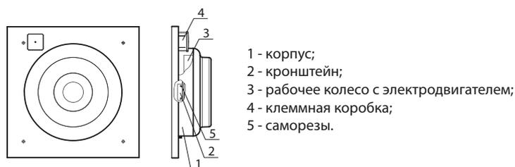
**Вентилятор серии ВЦ-ПН** состоит из корпуса 1 с закрепленным на кронштейне 2 электродвигателем с рабочим колесом 5. Кронштейн крепится к корпусу с помощью четырех саморезов 3. На выходном отверстии корпуса закреплена решетка. К верхней части корпуса со стороны входного патрубка крепится клеммная коробка 6 для подключения вентилятора к однофазной сети и размещения рабочего конденсатора.
