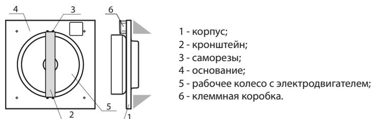
**Вентилятор серии ВЦ-ПК** состоит из корпуса 1 с закрепленным внутри на кронштейне 2 электродвигателем с рабочим колесом 3. Кронштейн 2 крепится к корпусу с помощью четырех саморезов 5. Сверху на корпусе крепится клеммная коробка 4 для подключения вентилятора к однофазной сети и размещения рабочего конденсатора.
