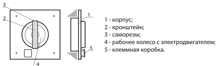
**Вентилятор серии ВЦ-ВН / ВЦЦ-ВН** состоит из корпуса 1. Внутри корпуса на кронштейне 2 закреплен электродвигатель с рабочим колесом 3. Корпус прикреплен к основанию с помощью саморезов 5. На корпусе сверху, со стороны входного патрубка, закреплена клеммная коробка 4 для подключения вентилятора к однофазной сети и размещения рабочего конденсатора.
