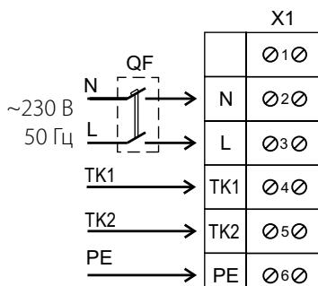
Схема підключення ВКП/ВКПІ 4Д 500\*300 (другий варіант), ВКП/ВКПІ 4Д 600\*300; ВКП 4Д 700\*400; ВКП 4Д 800\*500 із трифазним двигуном
