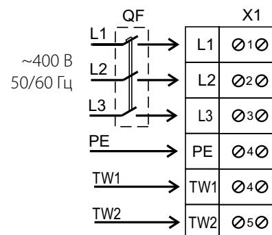
Схема підключення вентиляторів ВКП 4Д 600\*350; ВКПФ(I) 4Д 400\*200; ВКПФ(I) 4Д 500\*250; ВКПФ(I) 4Д 500\*300; ВКПФ(I) 6Д 600\*320; ВКПФ(I) 6Д 500\*300; ВКПФ(I) 4Д 600\*300; ВКПФ(I) 6Д 600\*300; ВКПФ(I) 4Д 600\*350; ВКПФ(I) 6Д 600\*350; ВКПФ(I) 4Д 700\*400; ВКПФ(I) 6Д 700\*400; ВКПФ(I) 4Д 800\*500; ВКПФ(I) 6Д 800\*500; ВКПФ(I) 8Д 800\*500; ВКПФ(I) 6Д 900\*500; ВКПФ(I) 8Д 900\*500; ВКП 4Д 1000\*500; ВКП 6Д 1000\*500; ВКПФ(I) 6Д 1000\*500; ВКПФ(I) 8Д 1000\*500
