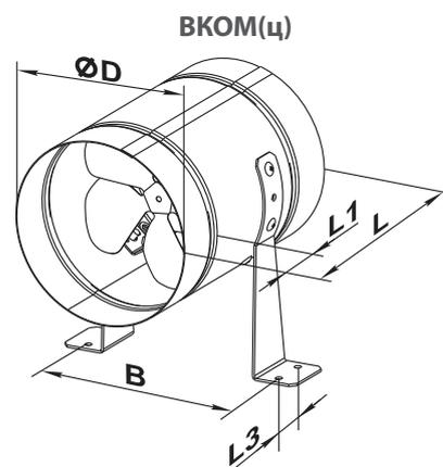
Для з'єднання вентиляторів **ВКОМ(ц)** із повітропроводами діаметром 150 мм, 200 мм та 250 мм передбачені редуктори **РМ(ц)** зі сталі з полімерним покриттям або з оцинкованої сталі. Редуктори не входять до комплекту постачання, замовляються окремо.
