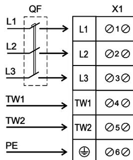
**Схема підключення до електромережі ОВ1, ОВК1, ВКОМ(ц), ВКОМ1(ц) з однофазним двигуном**
