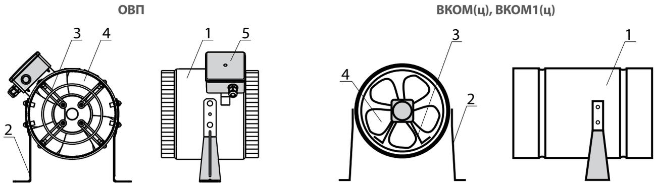
Вентилятор **ОВ1 Р** складається зі сталевого корпусу 1 із квадратним фланцем. Корпус має полімерне покриття. Двигун і крильчатка 5 встановлені всередині корпусу на кронштейні. Пластмасова решітка 2 встановлена у корпусі 1 та зафіксована рамкою 3. Вентилятор **ОВ1 Р** має клемну коробку 4 на шнурі для електричного підключення.
