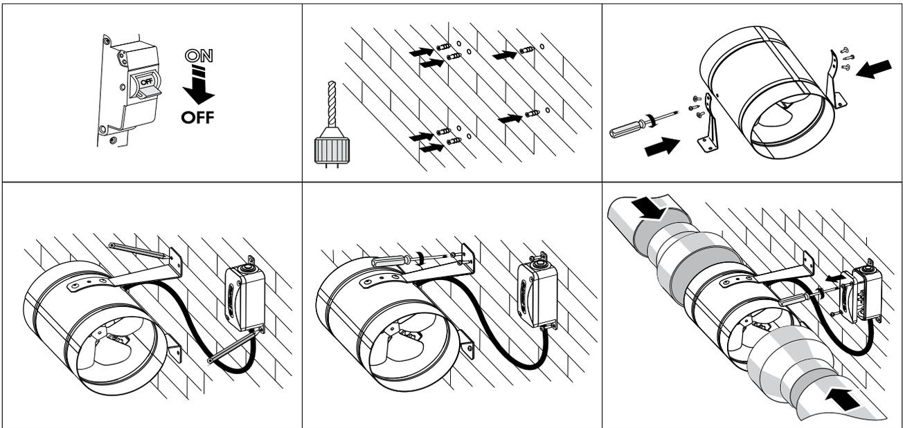
2. Примітка: місце кріплення кронштейна на корпусі вентилятора повинне бути таким, щоб самонарізи не перешкождали вільному обертанню крильчатки.
