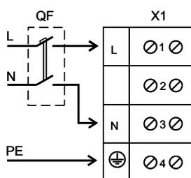
**Схема підключення до електромережі ОВ, ОВК, ВКФ з трифазним двигуном**
