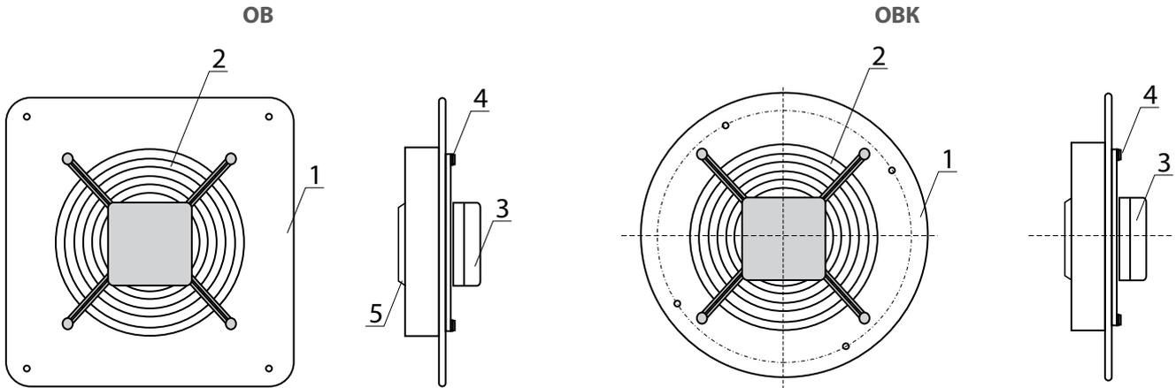
Вентилятори **ОВ1** та **ОВК1** складаються зі сталевого корпусу 1 з полімерним покриттям, із квадратним для **ОВ1** та круглим для **ОВК1** фланцем, до якого болтами 4 кріпляться решітка 2. Двигун і крильчатка 5 закріплені всередині корпусу на кронштейні. Ventilatori мають клемну коробку зі шнуром для виносного підключення.
