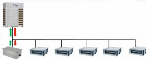
Режим розморожування з накопиченням тепла
